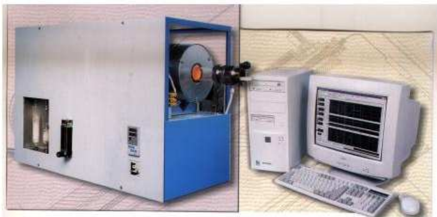
Rys. 1. Aparat do badania węgla błyszczącego z sondą NDIR, z zastosowaniem automatycznego analizatora typu AWB-50/1000
